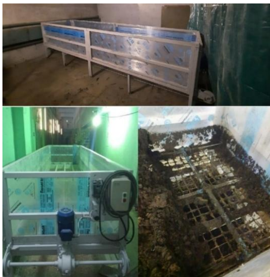
Рисунок 4 – Общий вид установки для производства вермикомпоста
